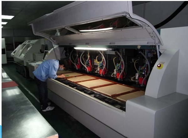
ドリル/Bore a hole
